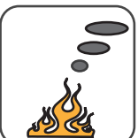
Low Smoke Emission IEC 61034-1&2 EN 50268-1&2/NF C32-073
